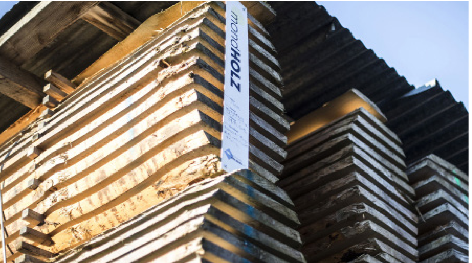
Mondholz braucht Zeit zum Trocknen. Hier sorgen Lättchen zwischen den Brettern dafür. Im Appenzellerland sprigeln genannt. Foto: Frehner Holzbau
